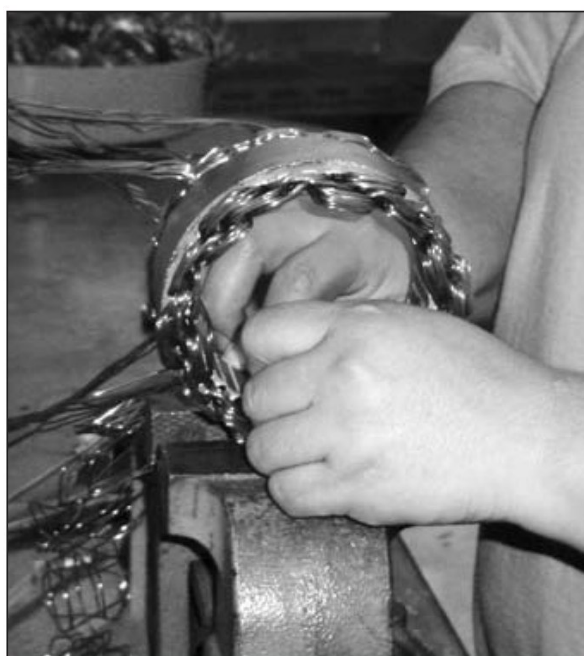
Eusebia Pinzana winds an R&R stator.
